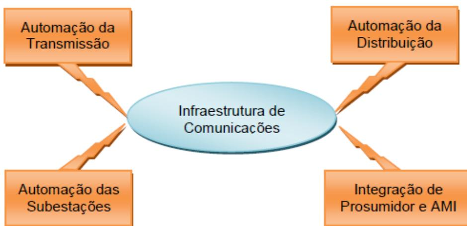
Figura 2.8: Segmentos da tecnologia *Smart Grid* [21].
